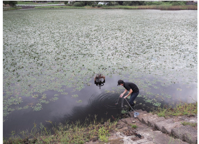
▲ ため池で分析機器による水質計測を行う様子
